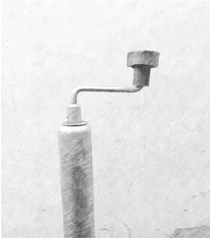
Подъём и опускание стрелы осуществляется ручкой подъемного механизма который расположен в передней части траншеекопателя. Вращение ручки против часовой стрелки опускает стрелу и цепь, вращение по часовой стрелки поднимает стрелу и цепь. Допускается перемещение цепи (диска) при опущенном рычаге вследствие остаточного зацепления ремня о приводной шкив, сила такого перемещения зависит от степени износа приводного ремня и других факторов.
